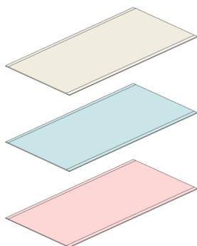
En paredes divisorias de locales secos se utilizará **placa Durlock® Estándar**, de 12,5mm ó 15mm de espesor.
