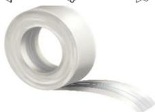
**Cinta Flex Corner:** Se utilizará como terminación de aristas formadas por planos que forman ángulos distintos a 90°. Se aplicará a la superficie de la placa con Masilla Durlock®, siguiendo los mismos pasos que para el tomado de juntas.
