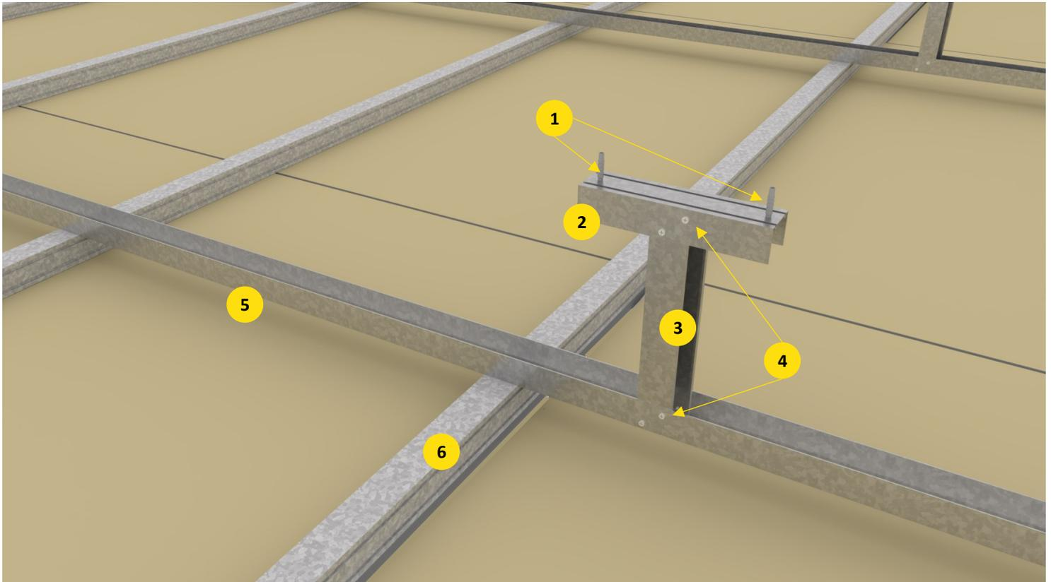
**1** Fijaciones**3** Montante de 34mm.**5** Solera de 35mm.**2** Solera de 35mm.**4** Tornillos T1**6** Perfil Montante 34mm. u Omega
