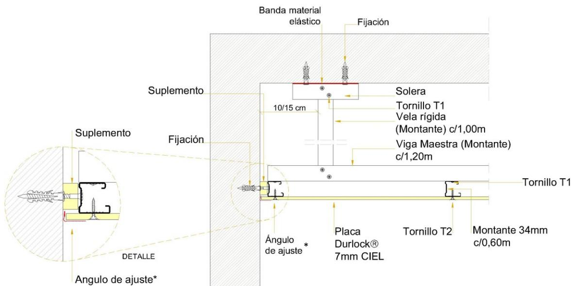
(\*) El perfil ángulo de ajuste o buña Z podrá fijarse con tornillos T2 colocados con una separación de 15cm. o con adhesivo de doble contacto. Luego recibirá dos manos de masilla Durlock®.
