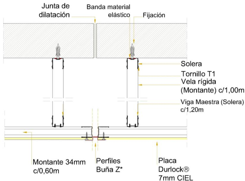
En grandes superficies se deben generar juntas de trabajo que definan módulos independientes, tanto la continuidad de la superficie de cielorraso como su estructura deberán ser interrumpidas mediante estas juntas ubicadas con una distancia máxima de 10m. en cualquier dirección, o en coincidencia con las juntas de dilatación del edificio.
