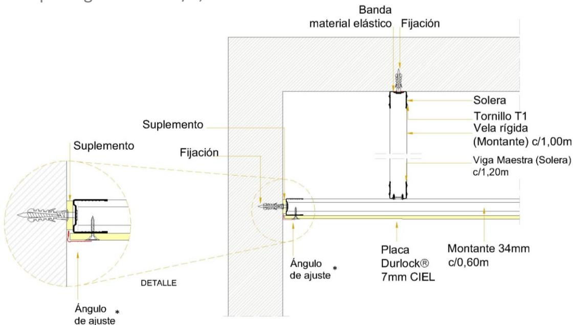
(\*) El perfil ángulo de ajuste o buña Z podrá fijarse con tornillos T2 colocados con una separación de 15cm. o con adhesivo de doble contacto. Luego recibirá dos manos de masilla Durlock®.
