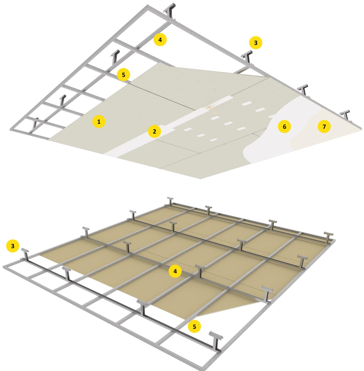
**1** Placa Durlock® CIEL**2** Tomado de junta**3** Vela Rígida C/ 1,00m.**4** Viga maestra C/ 1,20m.**5** Perfil Montante 34mm. u
