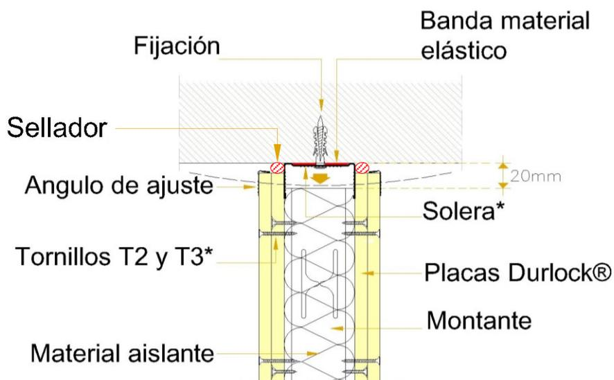
(\*) La solera superior no debe atornillarse a los perfiles Montante.
