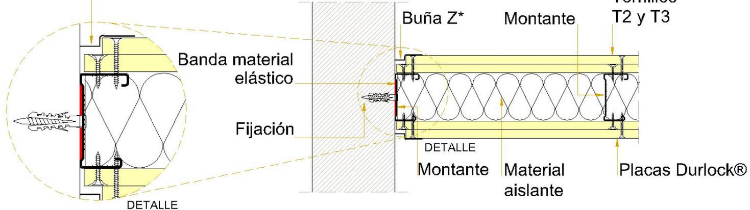
(\*) El perfil ángulo de ajuste y buña Z podrán fijarse con tornillos T2 colocados con una separación de 15cm. o con adhesivo de doble contacto. Luego recibirá dos manos de masilla Durlock®.
