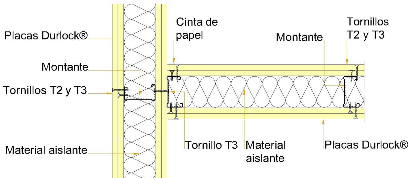
(\*) El perfil Cantonera podrá fijarse con tornillos T2 colocados con una separación de 15cm. o con adhesivo de doble contacto. Luego recibirá dos manos de masilla Durlock®.
