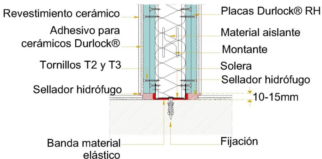
(\*) En caso de utilizar placas de 15mm. de espesor, el tornillo T3 se reemplazará por tornillos T4.
