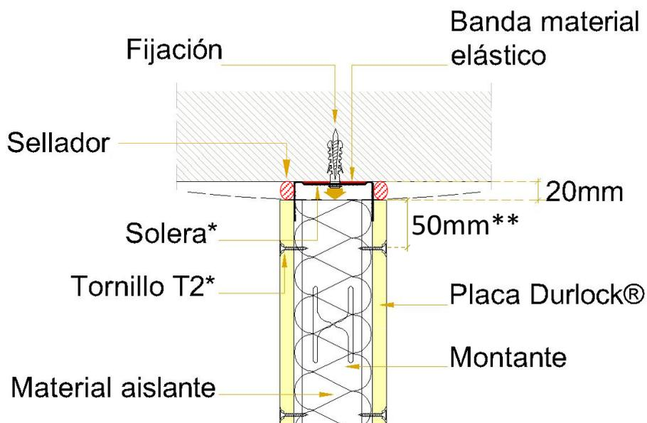
(\* ) La solera superior no debe atornillarse a los perfiles Montante.
