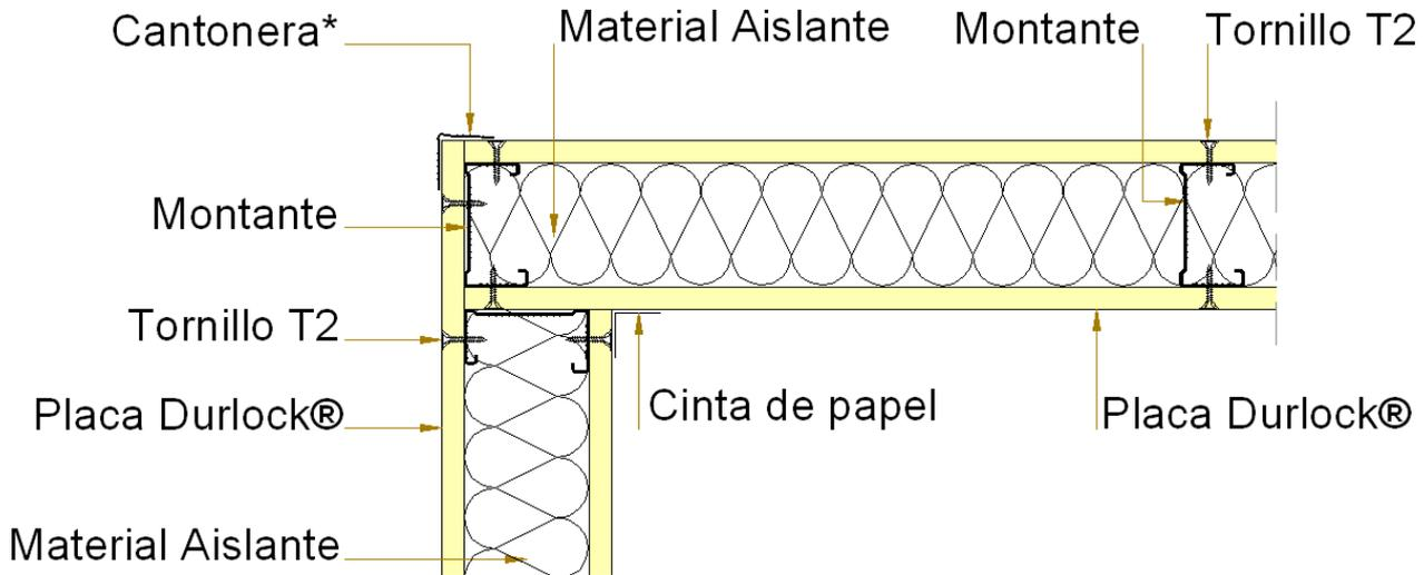
(\*) El perfil Cantонера podrá fijarse con tornillos T2 colocados con una separación de 15cm. o con adhesivo de doble contacto. Luego recibirá dos manos de masilla Durlock®.
