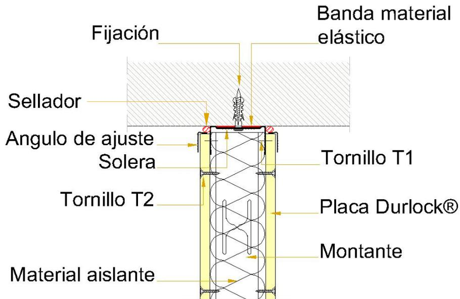
**Fijación de solera superior “flotante”.**
