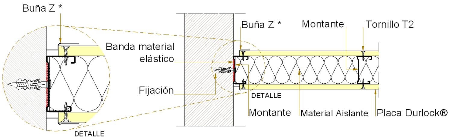
(\*) El perfil ángulo de ajuste y buña Z podrán fijarse con tornillos T2 colocados con una separación de 15cm. o con adhesivo de doble contacto. Luego recibirá dos manos de masilla Durlock®.
