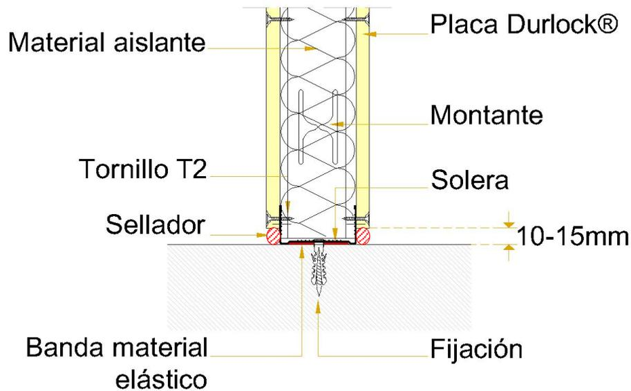
**Fijación de solera inferior. Ambientes húmedos. Solución banda + Sellador Hidrofugo.**
