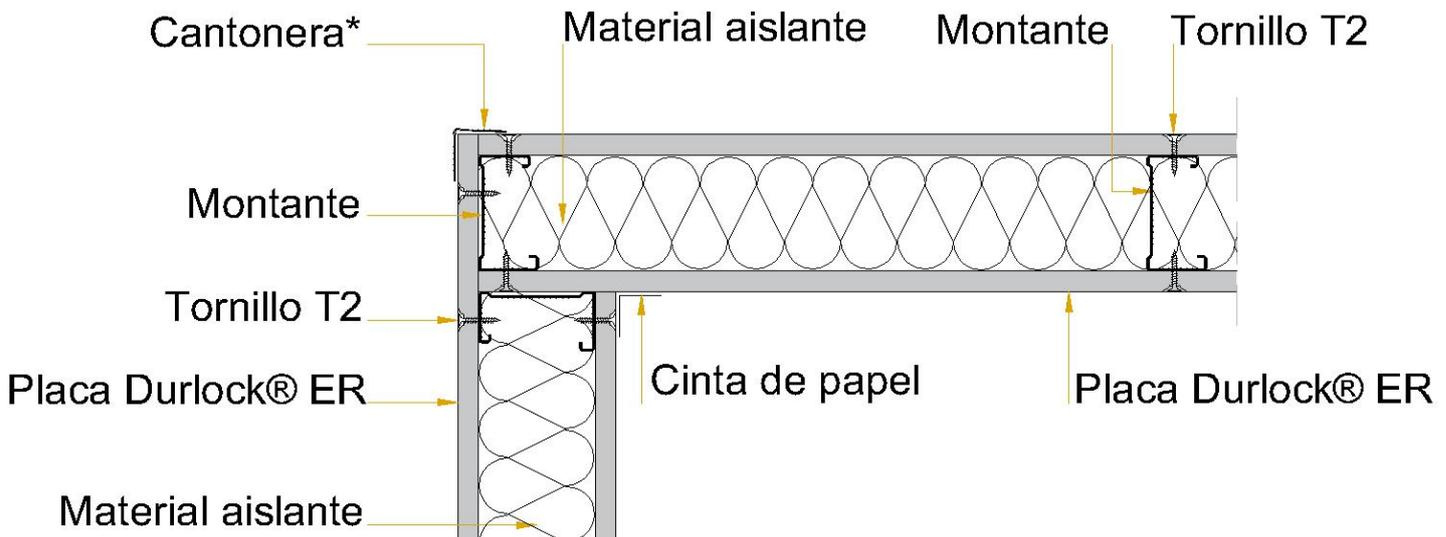
(\*) El perfil Cantonera podrá fijarse con tornillos T2 colocados con una separación de 15cm. o con adhesivo de doble contacto. Luego recibirá dos manos de masilla Durlock®.
