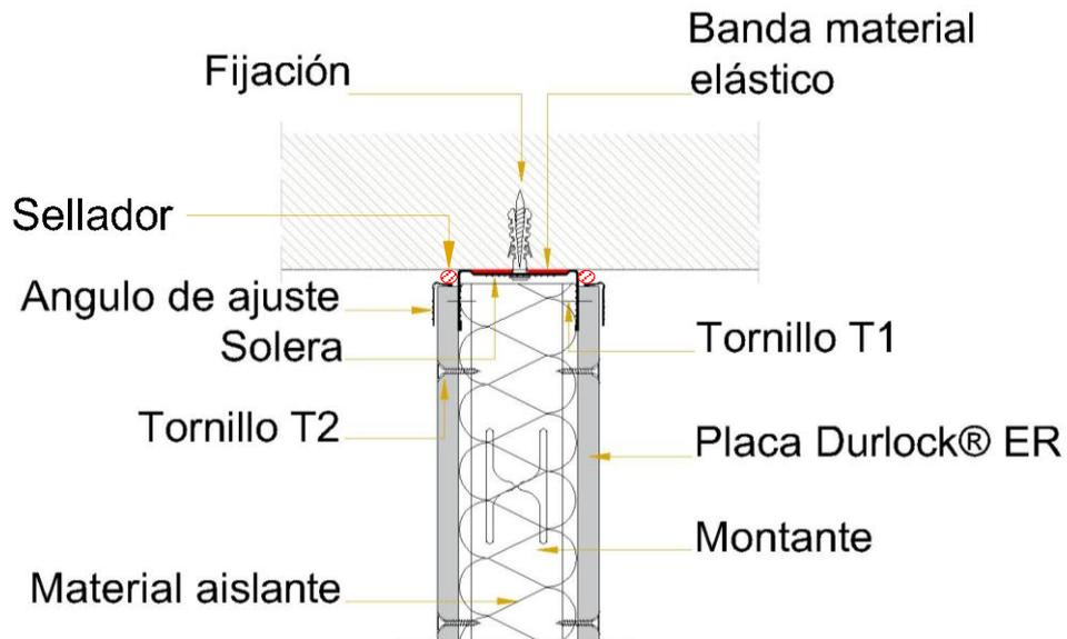
**Fijación de solera superior “flotante”.**
