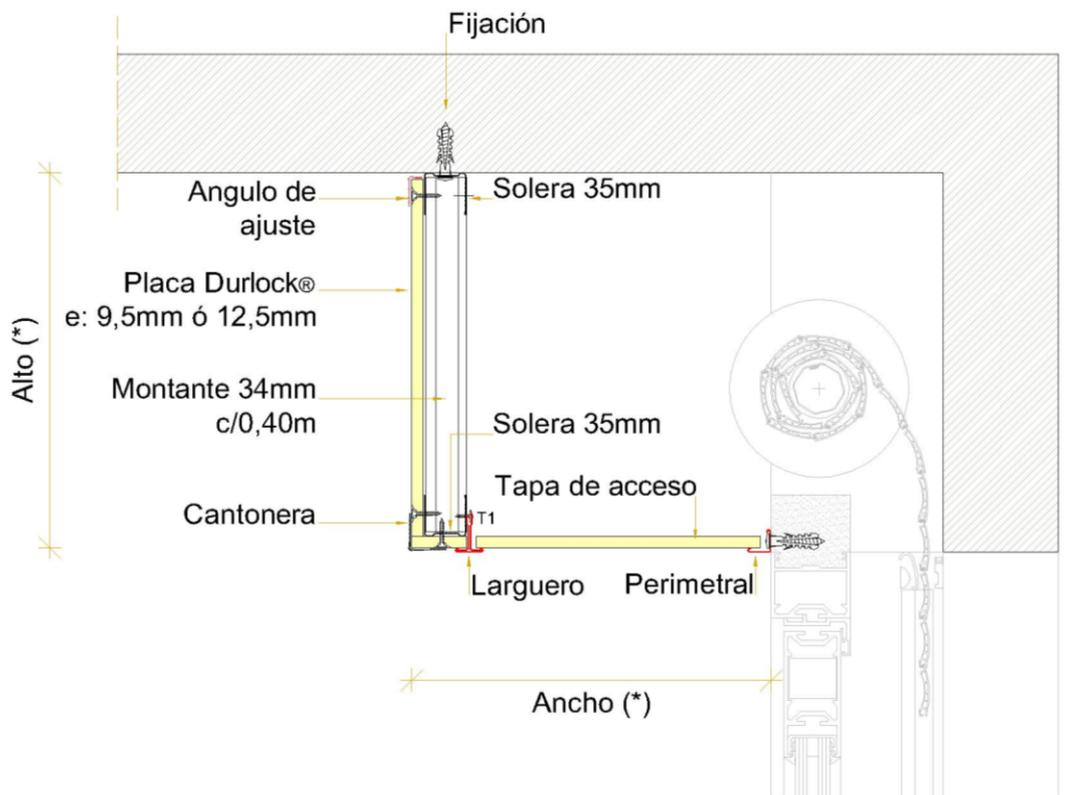
(\*) Para cajones de altura o ancho menor a 40cm., los montantes de 34mm. se colocaran con una separación de 60cm.
